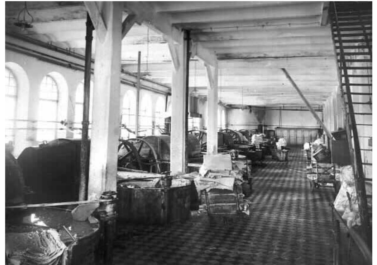
Kuva yllä Frenckellin paperitehdas sisäkuva, hollanteriosasto Kuvaaja: Atelier Laurent, Tampere Numero: 621:21 alkuper.kuva Lusto Lähde Tampereen museot, kuva-arkisto
